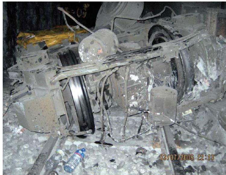
Tanmateix, tal com mostra l'informe sobre el seu estat, en arribar al taller, el cap d'acer se secciona, literalment, i se separa totalmente el bogie del xassís del tren.
